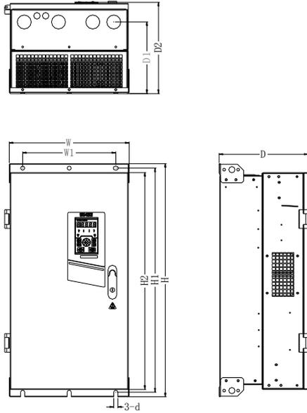
(d) Overall Dimensions of 90 kW – 400 kW Inverters
